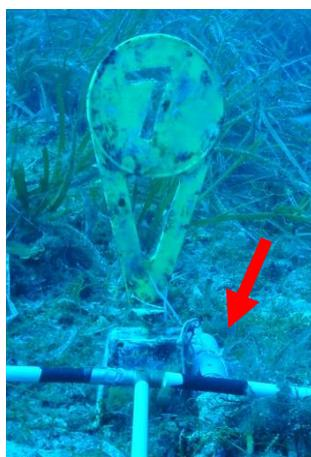
Les deux nouveaux capteurs ont été à nouveau installés, au niveau de la balise n°7 des balisages Nord et Sud (Figure 13), à respectivement 33 m et 32 m de profondeur. Ils ont été placés à l'intérieur d'un petit boîtier PVC opaque afin de les protéger des bio-salissures qui pourraient ultérieurement nuire à la récupération des données. Les boîtiers ont été perforés afin de permettre la circulation de l'eau.
