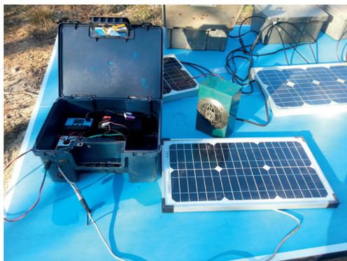
Figure 7. Une des sept repasses étanches à alimentation solaire, système Moyon (©SCOPS).
